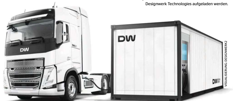
In 45 Minuten kann ein schwerer E-Lkw an der Mega-Ladestation des Winterthurer Unternehmens Designwerk Technologies aufgeladen werden.
